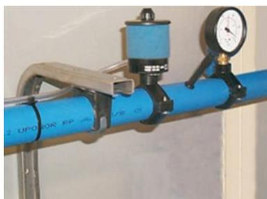
Комплект сервоуправления вакуума **VRM 1500**, производительностью 1500 л/мин при вакууме 50 кПа обеспечивает постоянный уровень вакуума в системе. Специальная запатентованная конструкция прибора обеспечивает высокий уровень надежности.
